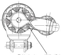
Tightening torque 10 Nm (8x).
